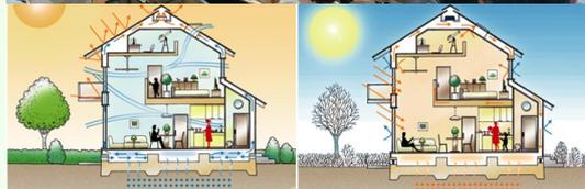
**夏 換気口 OPEN** 熱せられた空気は上昇気流となって、小窓裏の換気口から屋外に放出されます。また、床下の換気口から取り込んだ風が、床下空間の涼気とともに上昇し、室内の温度上昇を軽減してくれます。
